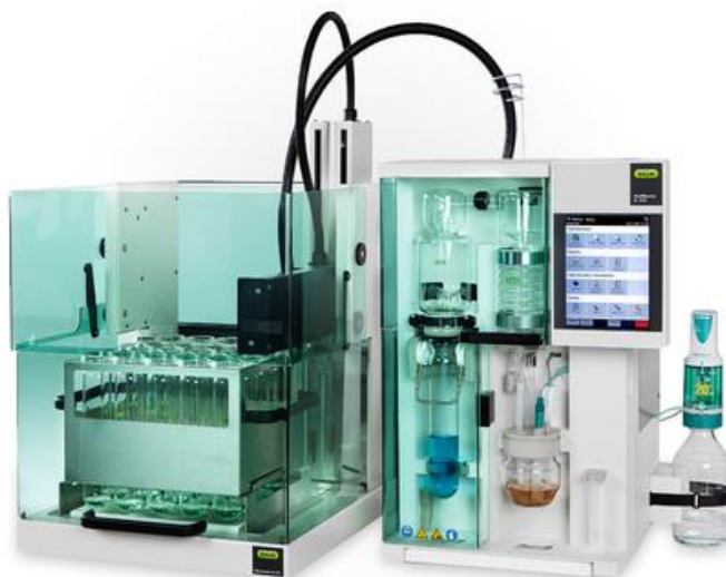
Рисунок 1 – Внешний вид анализатора общего, аммонийного и нитратного азота по автоматического модель К-370
